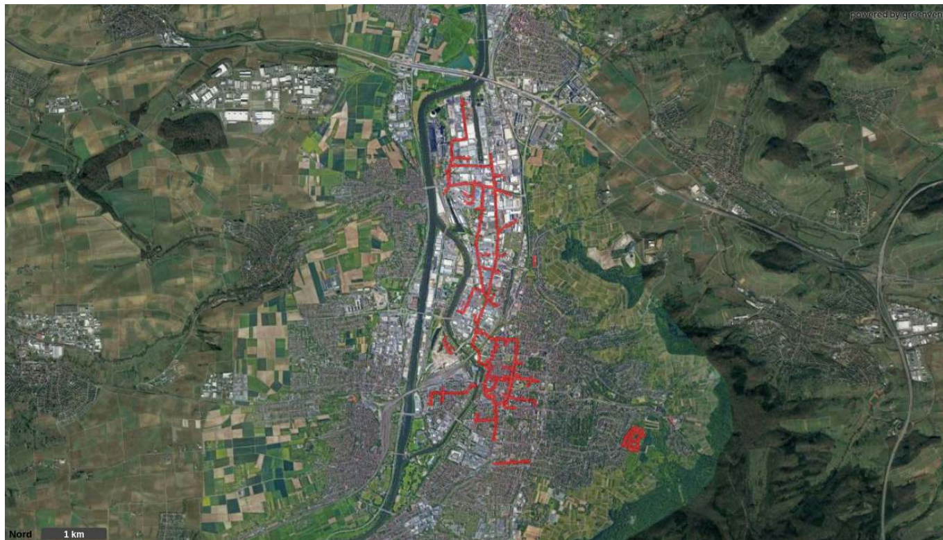
Abbildung 42: Bestehende Wärmenetze in Heilbronn 2
