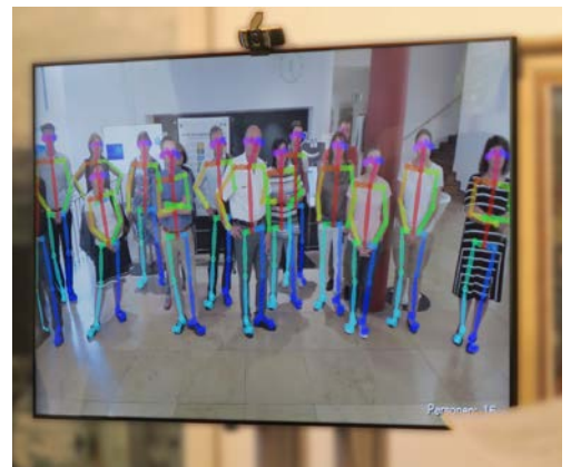
Maschinelernen, hier: eine Multipersonenerkennung in Echtzeit am Beispiel der offenen Programmibibliothek OpenPose
